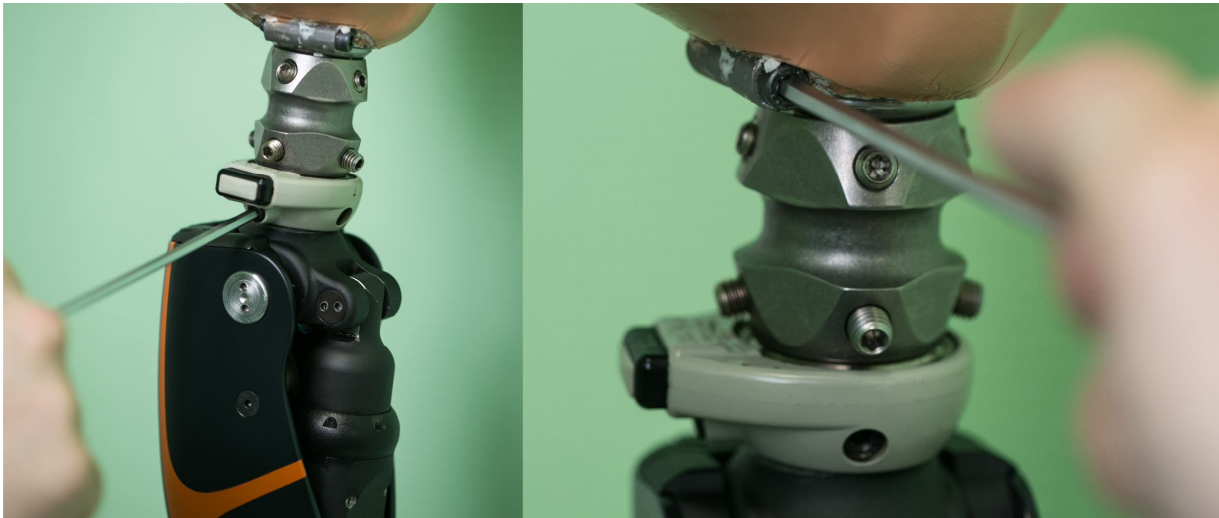
Рисунок 10 - Соединение МК с культеприемной гильзой
